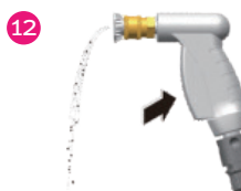
Rilasciare/spurgare tutta l'acqua contenuta nel circuito della pulitrice
